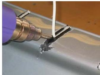
Съответната скорост на заваряване зависи от дебелините на заварявания детайл и на добавъчния материал. За заваряване трябва и двете да се намират в еднакво пластично състояние. Понататъшната обработка на ремонтираното място също като при заварка извършена със скоростна дюза.
